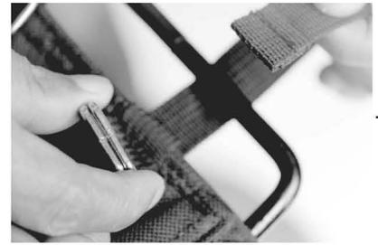
Riemen am Gepäckträger durch Umlegen um den äußeren, oberen Gepäckträger-Rahmen befestigen.
