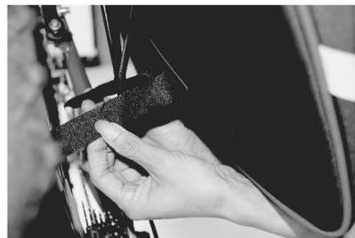
Befestigung durch Umlegen um den vertikalen Gepäckträger-Rahmen.
