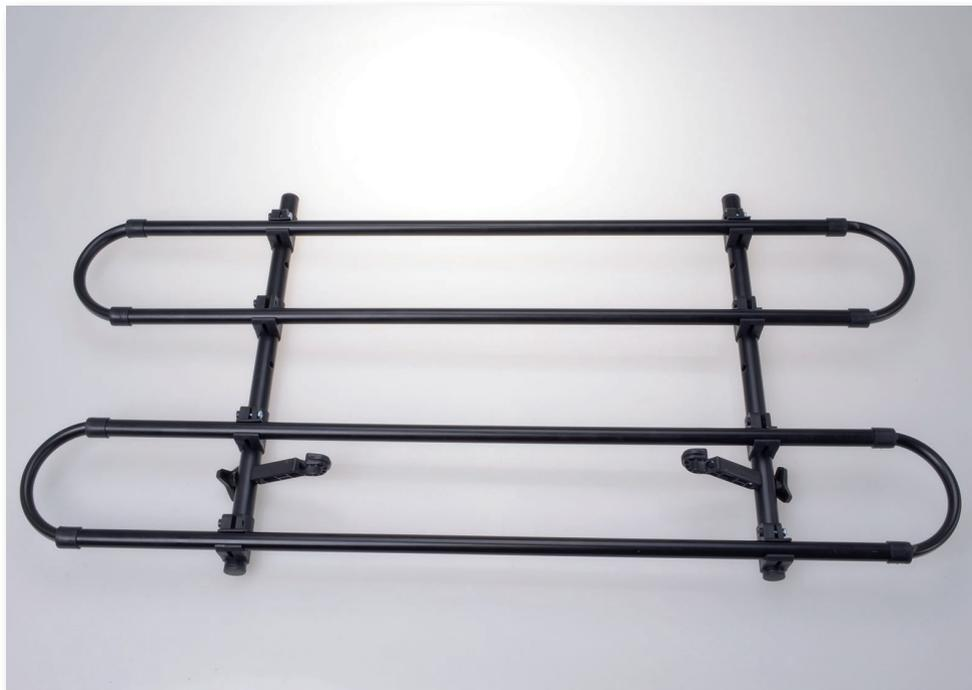
Haken Sie die Kunststoffhaken (E) nun an die Kopfstützenstangen ein und ziehen Sie die Schraubensätze (G) fest. Sie können nun die horizontalen Verstrebungen (C) auf die gewünschte Höhe verschieben und die Abschlussbügel (D) auf die gewünschte Breite herausziehen. Ziehen Sie anschließend die Schrauben der Kunststoffklemmhalterungen (B) fest.
