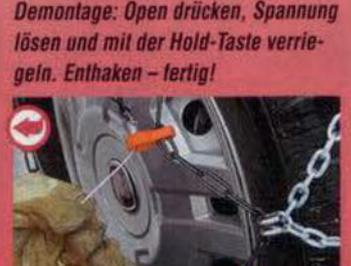
Demontage: Open drücken, Spannung lösen und mit der Hold-Taste verriegeln. Enthaken – fertig!
