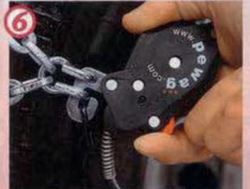
Knopfdruck: Verriegelungen öffnen – die Kette spannt sich selbstständig.
