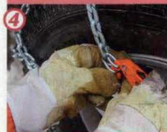
Kettennetz links und rechts auf Reifen legen, oberen Verschluss einhaken.
