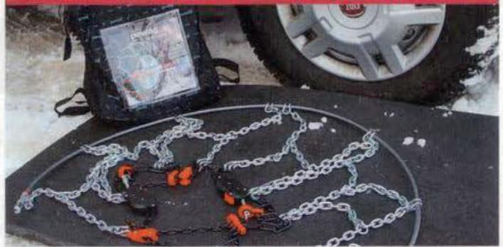
Das System von Pewag gefiel Reisemobil International besonders gut. Damit die Montage aber rund läuft, gilt es, einen Kniff zu beachten: Zuerst müssen die Spannseile aus der Spannvorrichtung gezogen und arretiert werden. So längt sich die Kette für eine unproblematische Montage.
