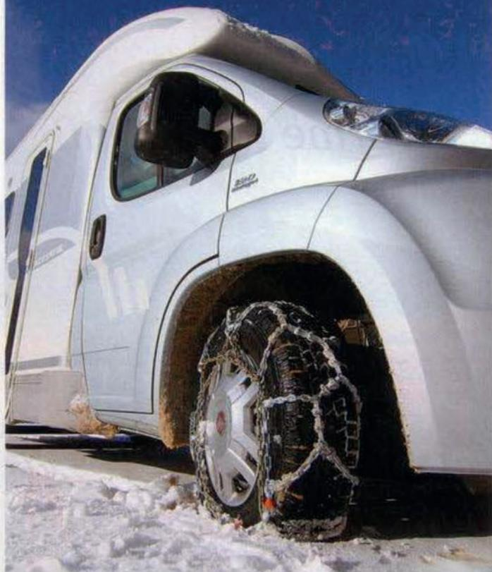
Sportmatic SUV von Pewag mit ihrem pffiffigen Spannsystem. Am Ende der Montage reicht ein Druck auf den Knopf und die Kette fixiert sich selbst fest auf dem Reifen. Perfekt!
